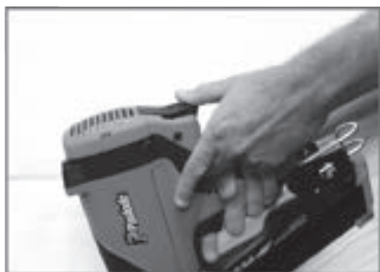
Pour fermer - Pousser vers l'avant, puis vers le bas pour verrouiller la porte du compartiment
