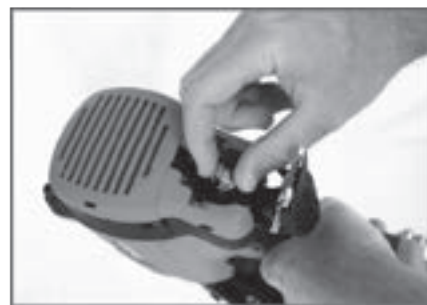
Aligner soigneusement l'adaptateur de carburant et la tige de la cellule
