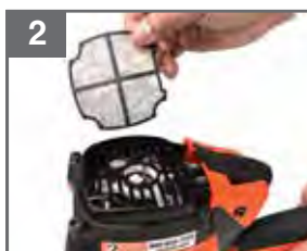
2 Tapoter doucement le filtre pour éliminer la poussière et les débris
