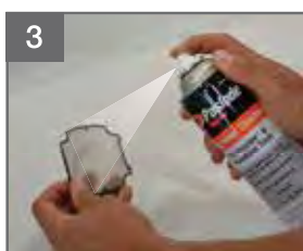
3 Utilisez le nettoyant pour outils sans fil Paslode ou un détergent doux et de l'eau pour nettoyer le filtre.
