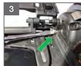
3 Remettre la lame de poussée en position de repos supérieure
