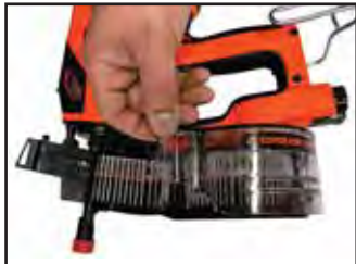
Fermer d'abord le couvercle du magasin
