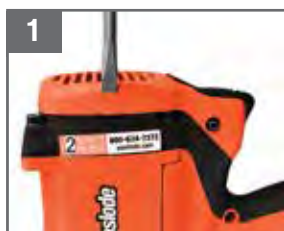
1 Utiliser un tournevis à lame plate pour retirer le capuchon.
