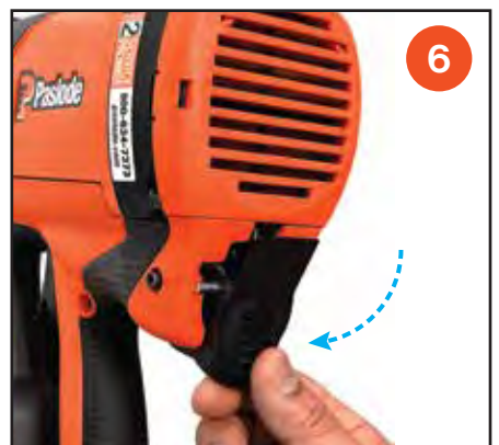
6 Pour fermer - Pousser vers l'avant, puis vers le bas pour verrouiller la trappe à carburant
