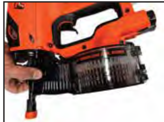
Fermer la porte de la buse et la verrouiller
