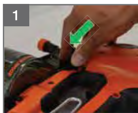
1 Pousser le loquet pour ouvrir la porte du magasin
