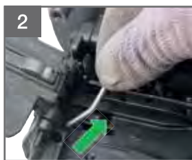
2 Dégager soigneusement le(s) clou(s)
